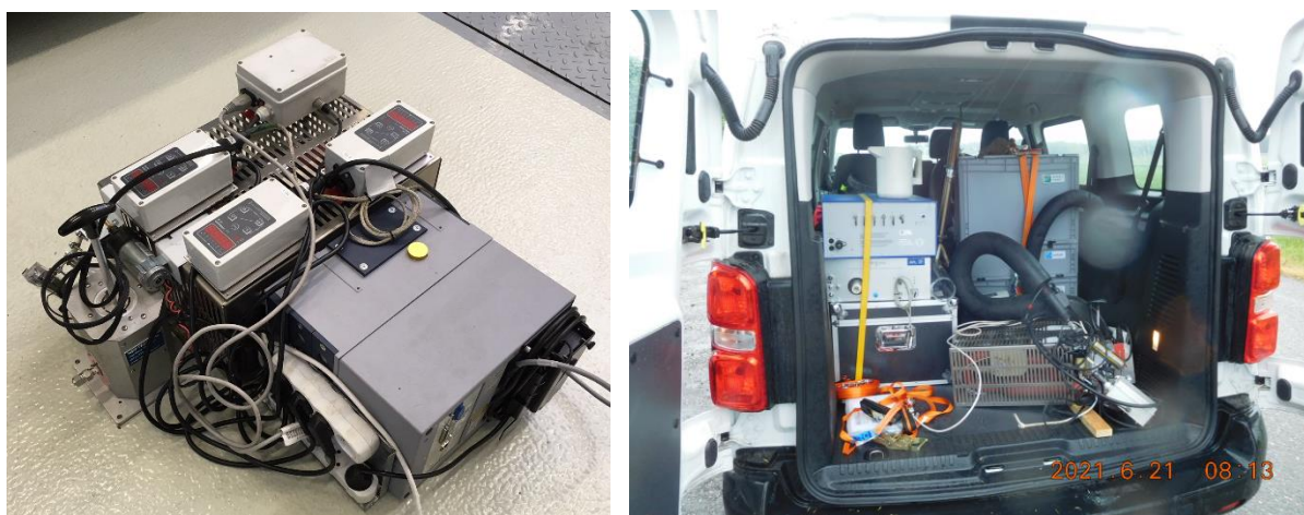
Obr. 1: FTIR analyzátoz (vlevo) a jeho instalace ve vozidle Toyota Proace (vpravo)
